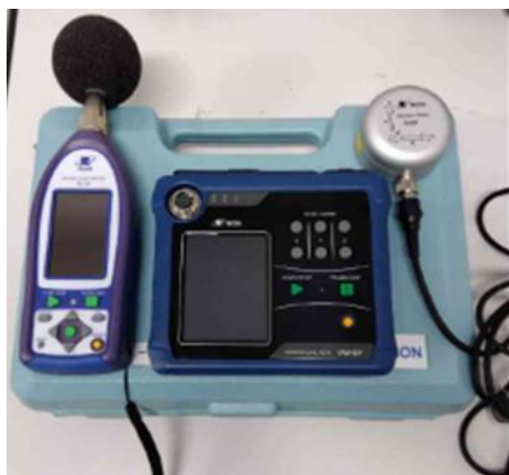
測定機器（左：騒音計 右：振動計）
