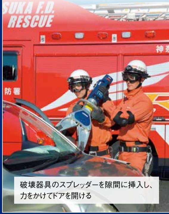
破壊器具のスプレッダーを隙間に挿入し、力をかけてドアを開ける
