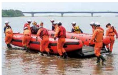
一度に最大20人を収容でき、車椅子のままでも乗れる。船底を補強布で保護しているため、がれきなどが散乱する浸水域でも活動ができる。最大積載重量は約2トンのため、大量の物資も運べる。
