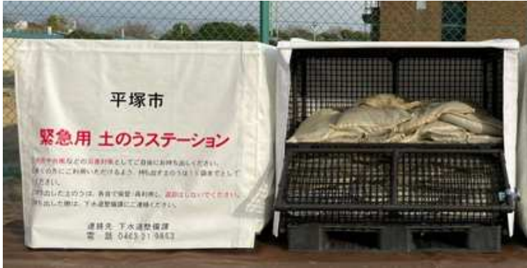
土のうステーションの例
