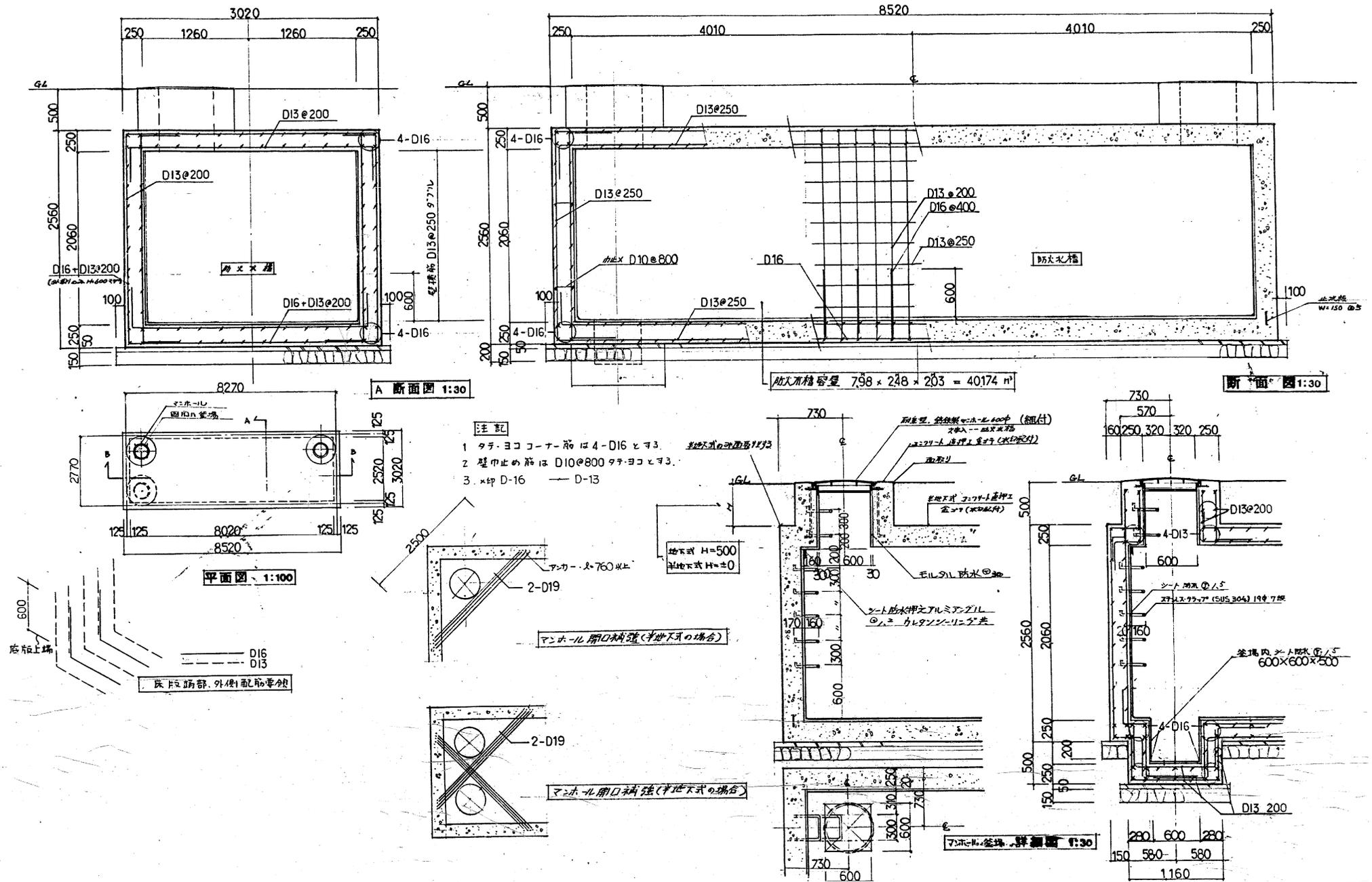
防火水槽 平面図 断面図
