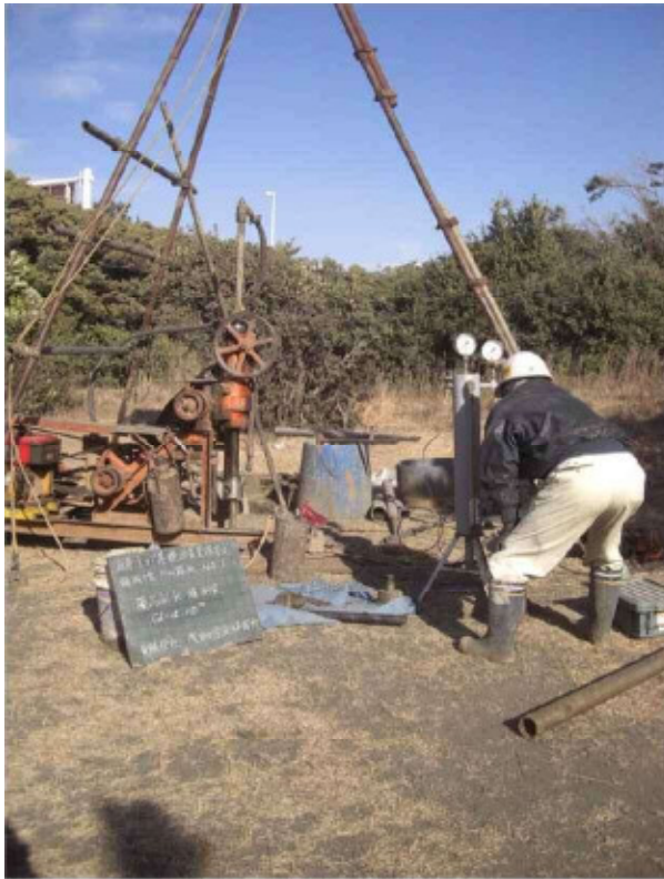
孔内水平載荷試験
