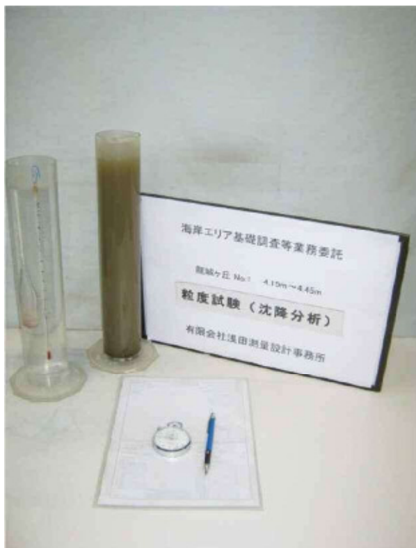
粒度試験（沈降分析）
