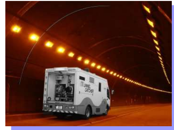
トンネル・道路自動計測業務
