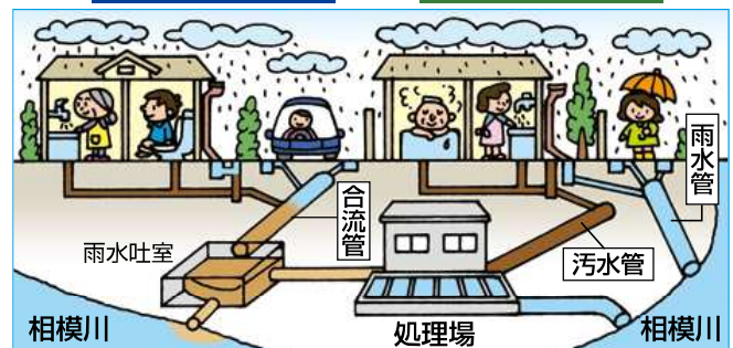
△図1 合流式と分流式の仕組み
