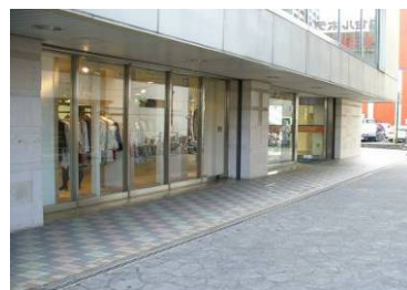
右写真：1階部分をセットバックし、歩行者を引き込む工夫がされている
